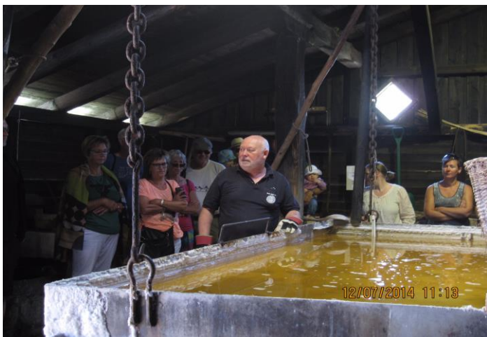
Saltsyderen fortæller om den komplicerede proces, hvor saltet udfældes ved ca 70 grader (HA).
